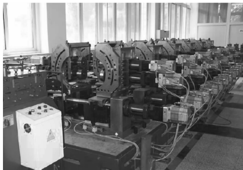
图 8 变截面辊弯成形生产线
