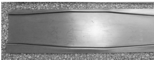
图 9 变截面辊弯成形零件
